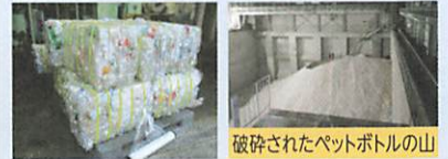
圧縮後、破碎施設に運び、細かく破碎します
