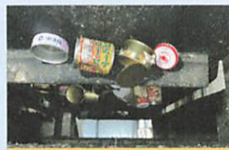
磁石にくっつくスチール缶 磁力を使い、アルミ缶とスチール缶に分別します
